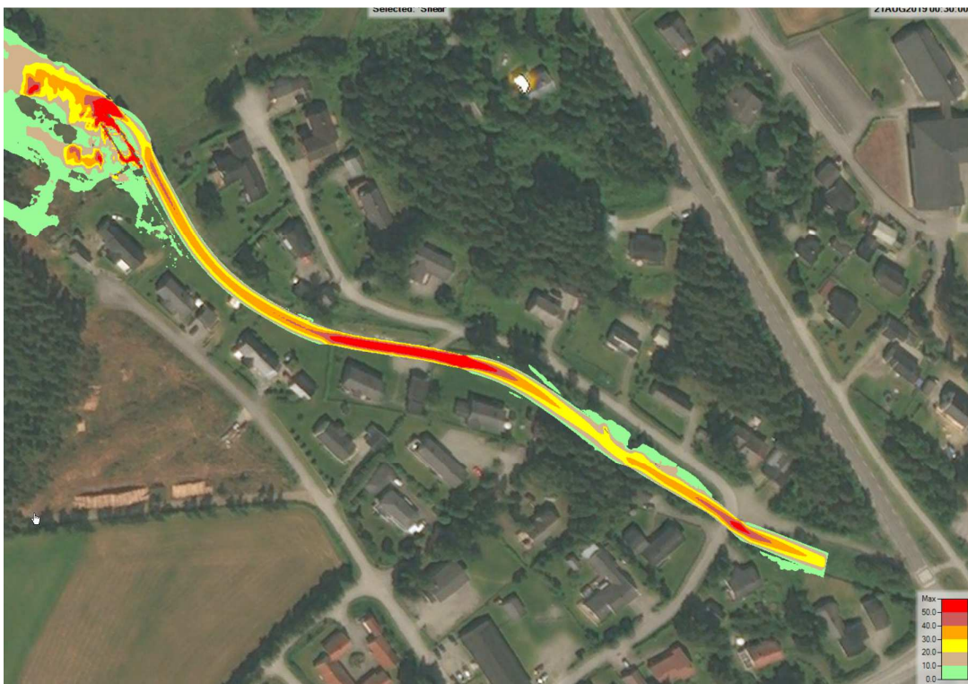
Figur 11 Dimensjonerende skjærspenning ( \text{N}/\text{m}^2 ), Q = 18 \text{ m}^3/\text{s}
