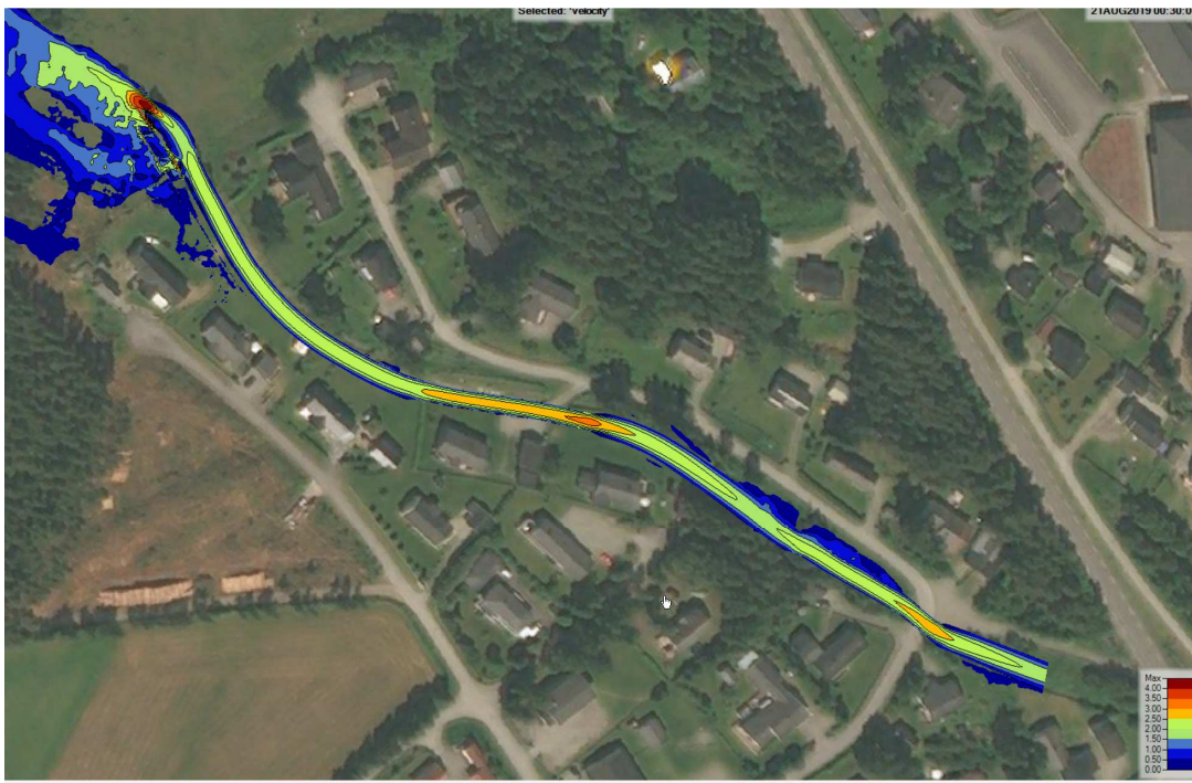
Figur 10 Dimensjonerende vannhastighet (m/s), Q=18 \text{ m}^3/\text{s}
